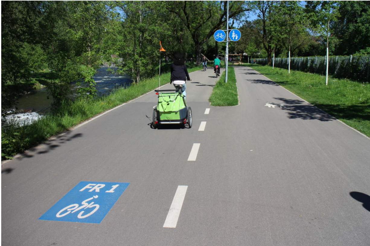
Abbildung 4.6 Freiburg im Breisgau - Rad-Vorrang-Route FR1 Dreisamuferweg: Streckenabschnitt mit neuer, sicherer Trennung des Fuß- und Radverkehrs. Breite Radweg: etwa 3 m; Breite Gehweg: etwa 2,5 m. Der Gehweg wurde hier abseits des Wassers angelegt, da im weiteren Streckenverlauf in Blickrichtung rechts des Fußwegs ein Spielplatz liegt. Freiburg verwirklicht statt eines stadtweiten Netzes von Radschnellverbindungen „nur“ ein „Rad-Vorrang-Netz“. Hintergrund ist, dass die FGSV-Kriterien nach dem Merkblatt für Radschnellverbindungen vom Platz her nicht überall anwendbar sind. Bild: Dirk Schmidt 05-2015.
